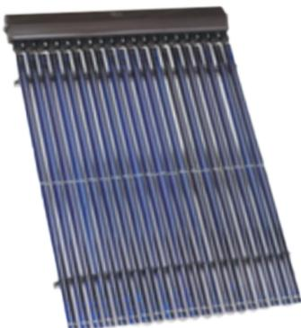
Utilisant la technique du caloduc (principe « Heatpipe »), le capteur solaire à tubes sous vide **Vitosol 300-T** ne laisse pas circuler directement le fluide solaire dans les tubes.
